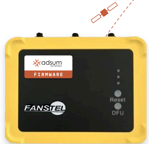
nRF9151 BACK SATELLITE NB-NTN · LTE-M · GNSS
